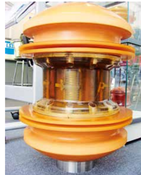
SMARTER STÖPSEL: Ein Lippenmolch aus Polyurethan. In der Taille sind die Magnetkerne zu erkennen.
