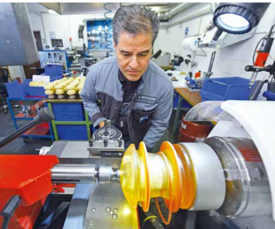
MASSARBEIT: Ali Mostafaie bearbeitet einen Kunststoffmolch auf der Drehbank.
